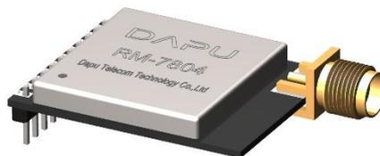
RM7804 模块是低功耗低速率远距离传输模块，采用了 Semtech 公司的高性能扩频射频芯片 SX1278，用于超长距离扩频通信，抗干扰性强且具有超过-142dBm 的高接收灵敏度。同时模块内嵌 STM8L1 低成本低功耗单片机。
