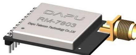
RM7803 模块是低功耗低速率远距离传输模块，采用了 Semtech 公司的高性能扩频射频芯片 SX1278，用于超长距离扩频通信，抗干扰性强且具有超过-142dBm 的高接收灵敏度。同时模块内嵌 STM32L0 高性能低功耗单片机。
