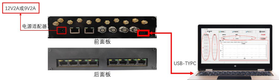
图 1-4 上位机与测试仪连接示意图
