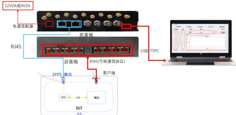
图 6-1 参数补偿连接示意图
