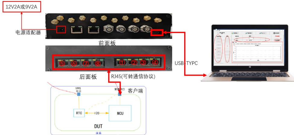
图 5-1 读写 RTC 连接示意图
