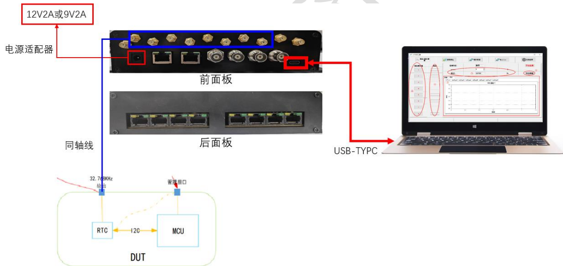
图 2-1 频率测量测试框图
