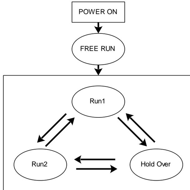
Run1: 快速捕获。上电开始计时, 2min 后开始提供快锁标志, 3min 后开始快速调整 OCXO 输出频率使分频 1PPS 能够捕获 1PPS 参考源。
