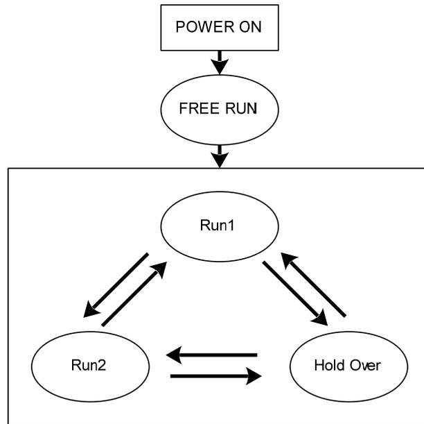
Run1: 快速捕获。快速调整OCXO 10MHz输出频率使10M分频1PPS能够捕获1PPS参考源。
