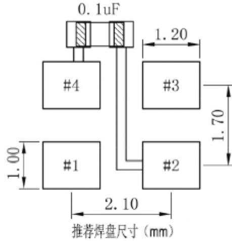
(注: 0.1uF 电容应尽可能靠近晶振的4脚。)
