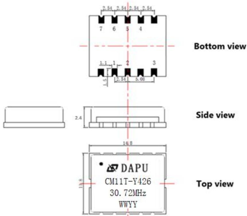
图 3: 机械结构
