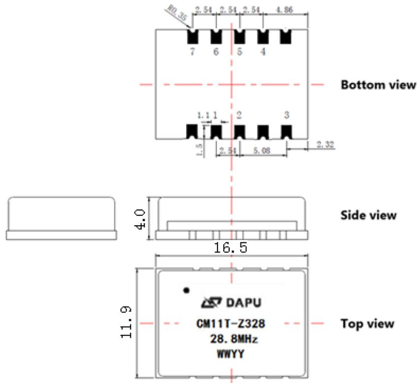
图 3: 机械结构
