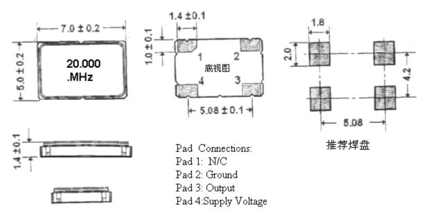
注: 有切脚的焊盘为1脚,底视图为焊盘正对着观察者 单位: mm
