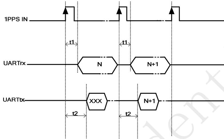
如图示为模块稳定锁定后 TOD 输入输出的时序图:
