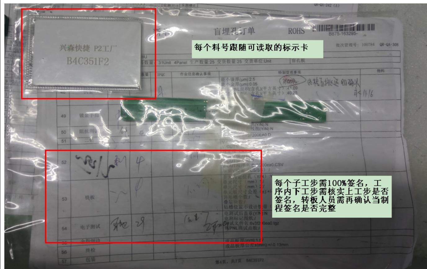
4. 对终检员工进行培训，检验前除查看常规阻焊字符颜色面次等信息外，还需额外留意是否有特殊流程，如 V-cut、控深铣等，如果有特殊流程，检验前需确认板面有无此类特殊流程加工，以避免漏加工流程漏失。
