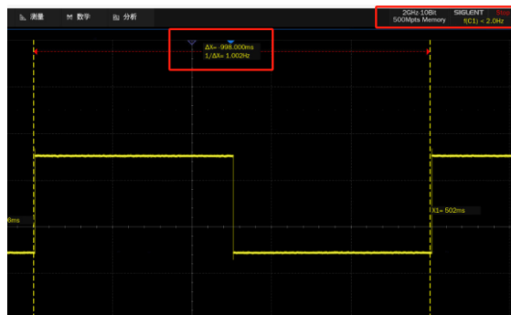
图表 2-9 FOUT 输出示意图
