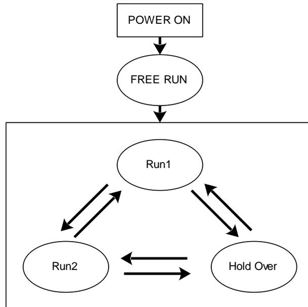
Run1: 快速捕获。上电开始计时，3min后开始快速调整OCXO 10MHz输出频率使10M分频1PPS能够捕获1PPS参考源。
